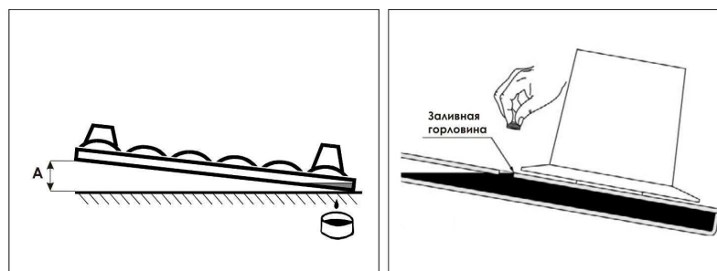
Рисунок 7.3 - Проверка уровня масла в режущем аппарате
