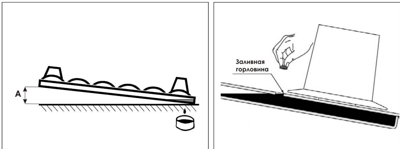
Рисунок 8.3 – Проверка уровня масла в режущем аппарате
