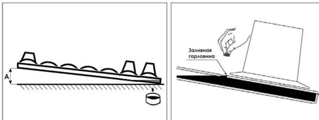
Рисунок 8.3 – Проверка уровня масла в режущем аппарате
