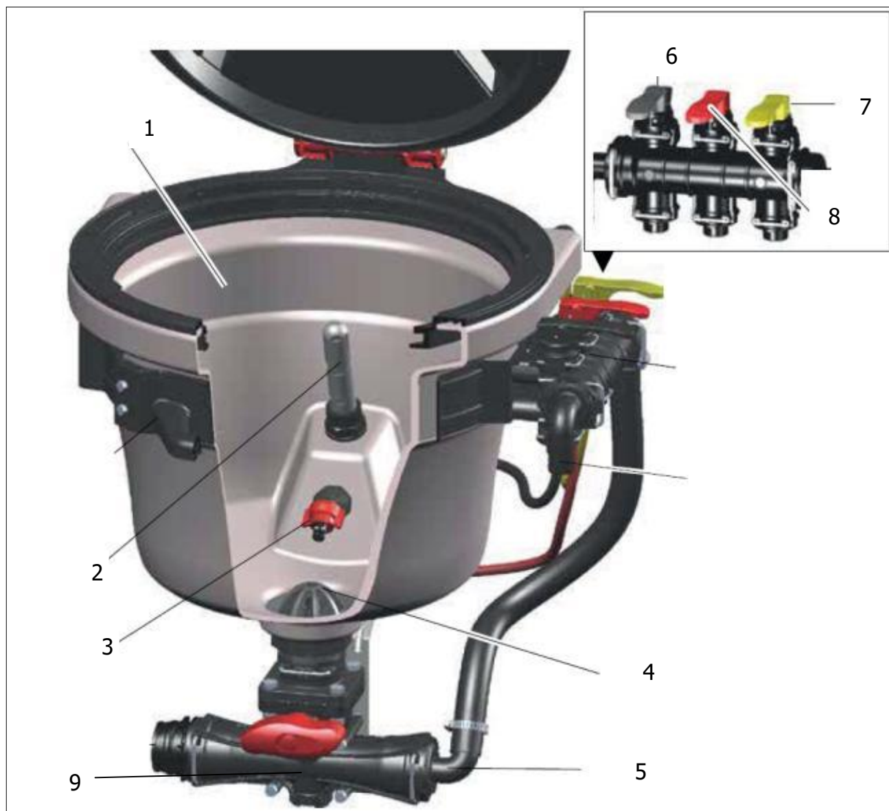
1 – Емкость 30 л; 2 – Форсунка для промывки тары; 3 – Форсунка перемешивания; 4 – Сетчатый фильтр; 5 – Эжектор; 6 – Кран промывки тары (черный); 7 – Кран промывки миксера (желтый); 8 – Кран перемешивания (красный); 9 – Кран опорожнения миксера
