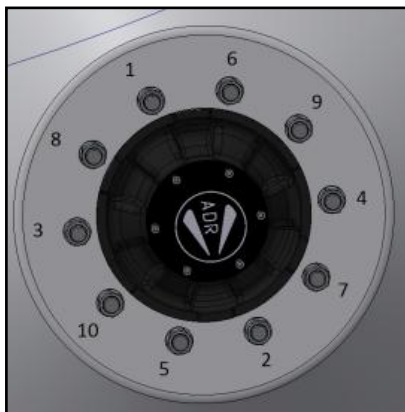
Рисунок 5.1 – Порядок затяжки колесных гаек
