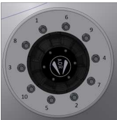
Рисунок 5.1 – Порядок затяжки колесных гаек
