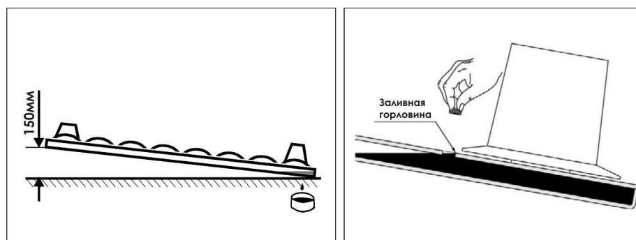
Рисунок 7.3 - Проверка уровня масла в режущем аппарате
