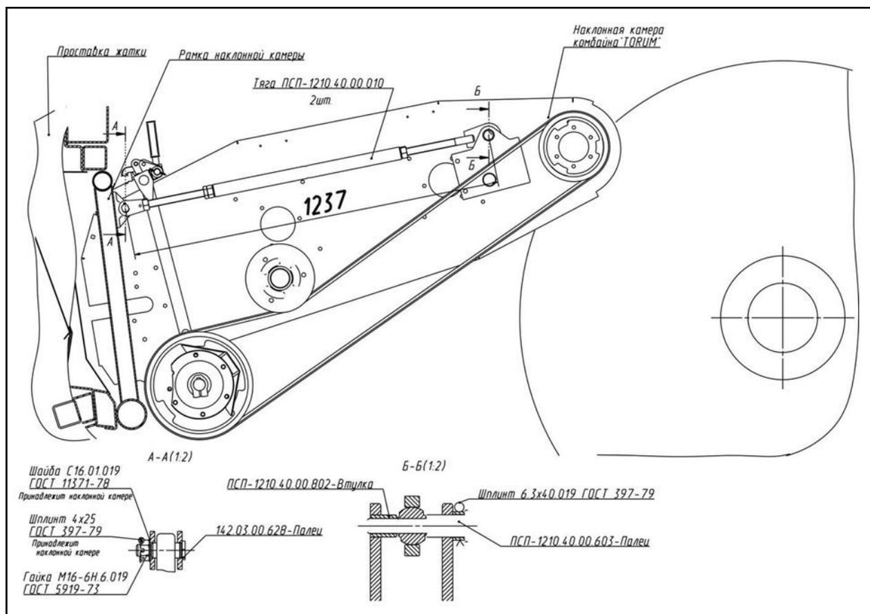
Рисунок 6.8 – Установка тяг на наклонную камеру комбайна «TORUM»
