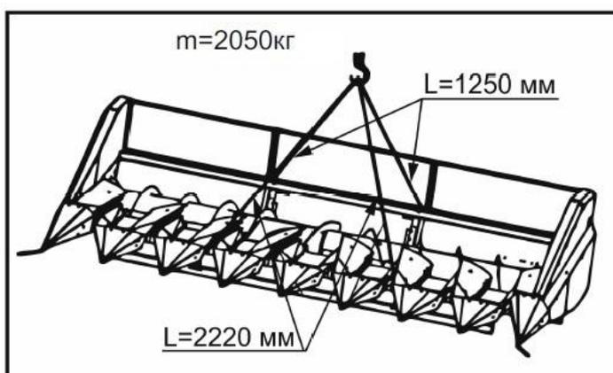
Рисунок 9.1 – Схема строповки
