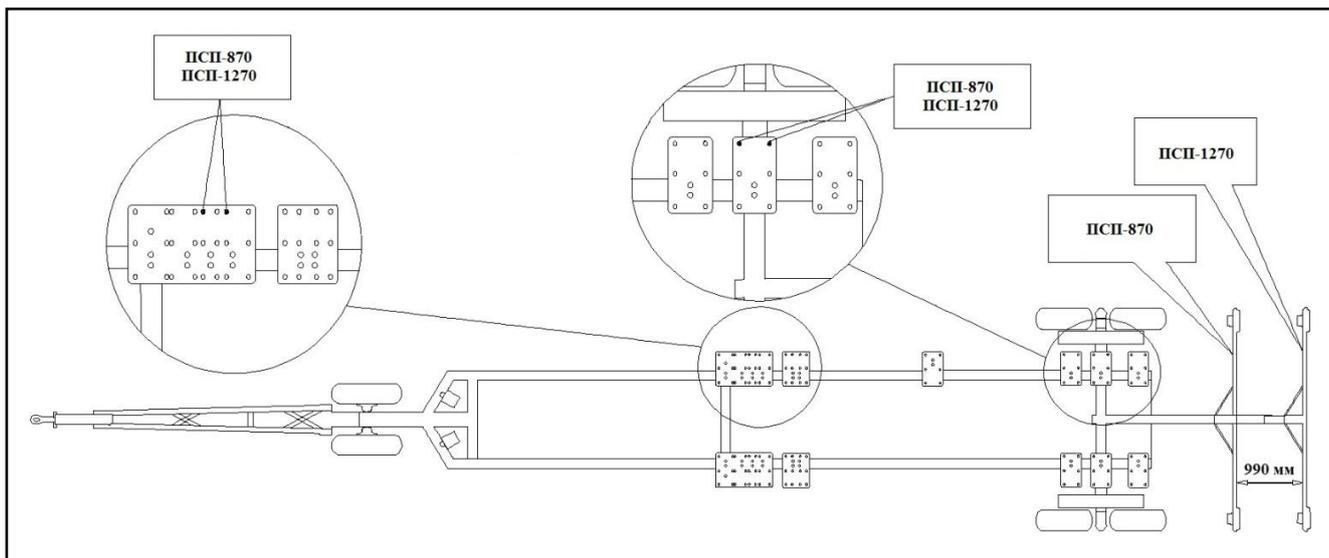
Рисунок 9.3 – Установка опор приспособления ПСП-870
