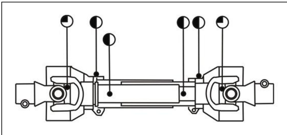
Рисунок 8.2 – Места и периодичность смазки карданного вала
