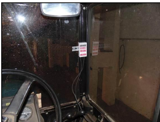
Рисунок 5.26 – Установка пульта управления в кабине трактора
