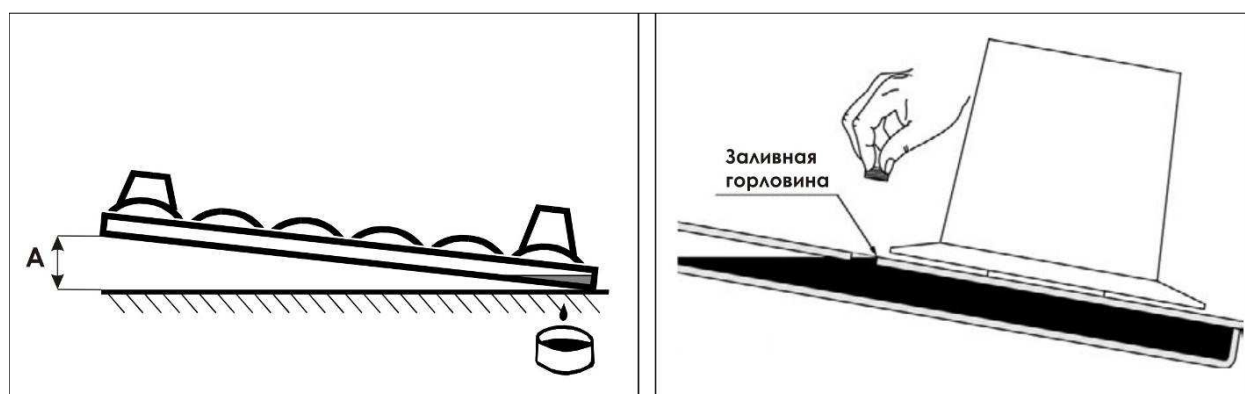
Рисунок 7.3 - Проверка уровня масла в режущем аппарате
