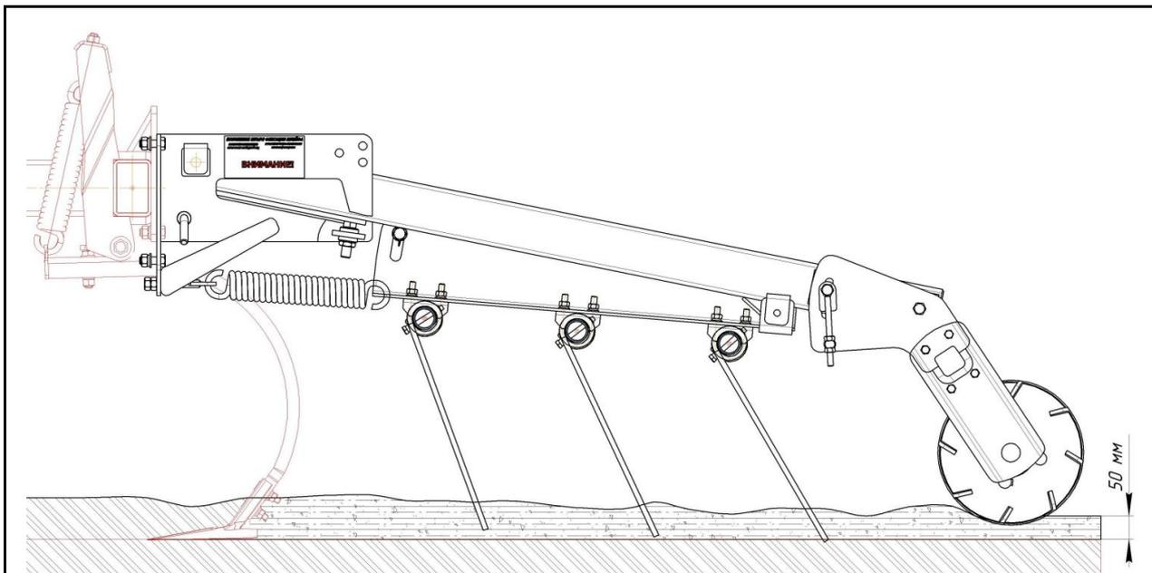
Рисунок 24.8 – Положение комбинированного шлейфа при глубине обработки 5 см
