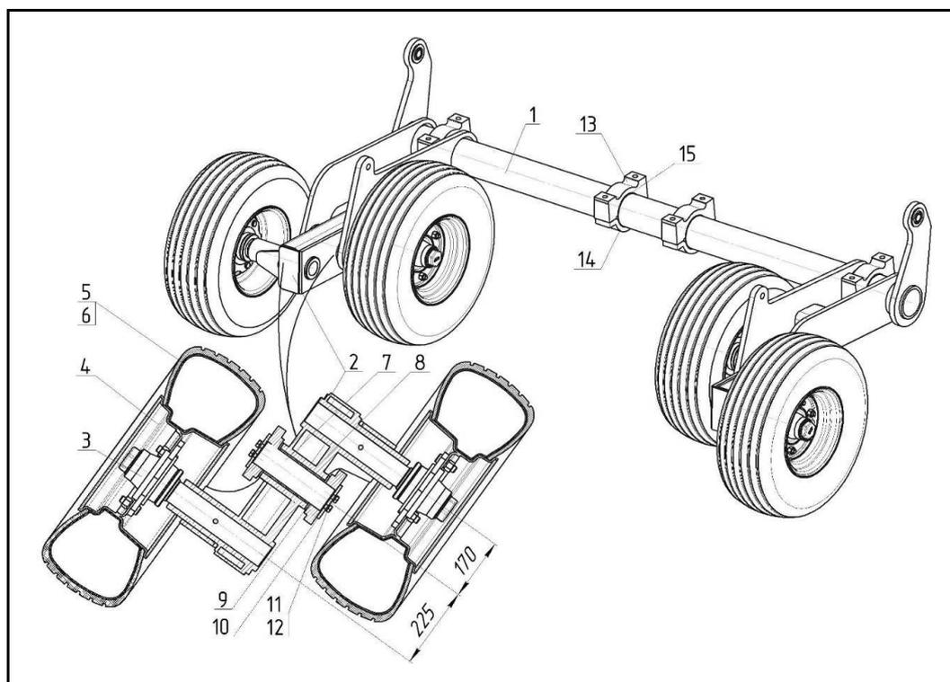
1 – Рама шасси; 2 – Балансир; 3 – Ступица колеса; 4 – Колесо 9.00x15.3; 5 – Шина 10,0/75-15,3-ИМ-04-14PR;
