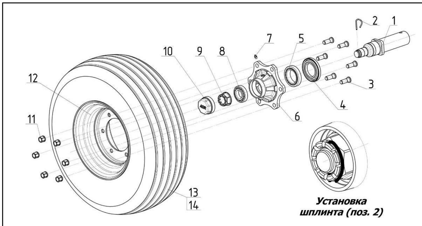
1 – Ось колеса; 2 – Шплинт пружинный; 3 – Болт 9RC18-16G; 4 – Защитное уплотнение; 5 – Подшипник;
