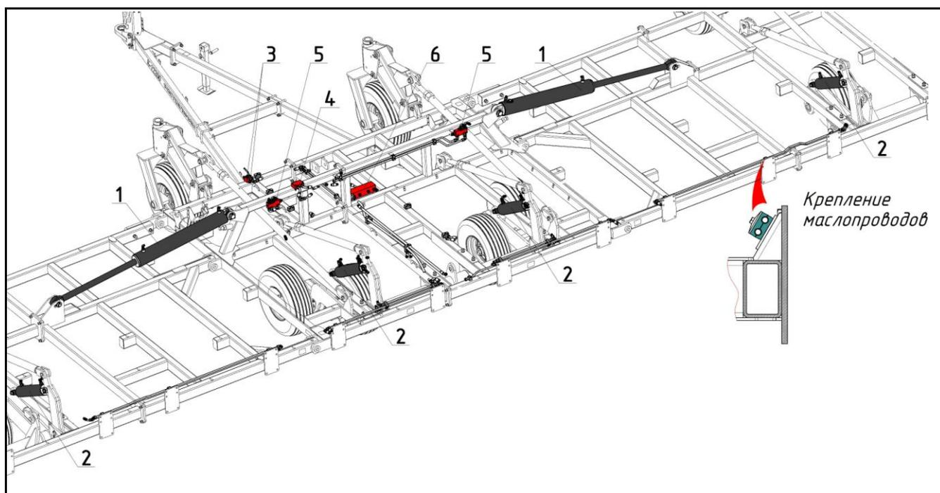
1 – Гидроцилиндр ЦГ-125.60x900.11; 2 – Гидроцилиндр МС 100/50x400-20;
