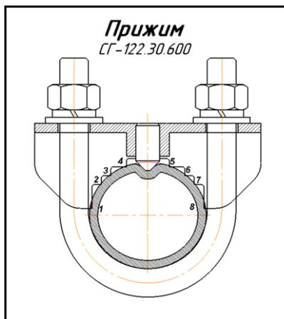
Рисунок 24.6 – Затяжка прижимов граблин комбинированного шлейфа
