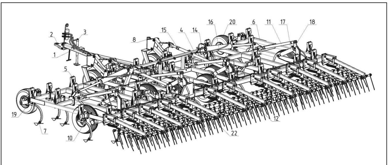
1 – Сница; 2 – Прицеп; 3 – Домкрат; 4 – Рама в сборе; 5 – Крыло левое; 6 – Крыло правое; 7 – Рабочий орган; 8 – Колесо флюгерное; 10, 11 – Шасси крыла; 12 – Шасси; 14 – Тяга регулировочная; 15 – Тяга синхронизации; 16 – Гидроцилиндр подъёма крыла; 17 – Гидроцилиндр шасси; 18 – Кронштейн; 19, 20 – Колесо опорное; 22 – Шлейф пружинный (бороновальные модули)
