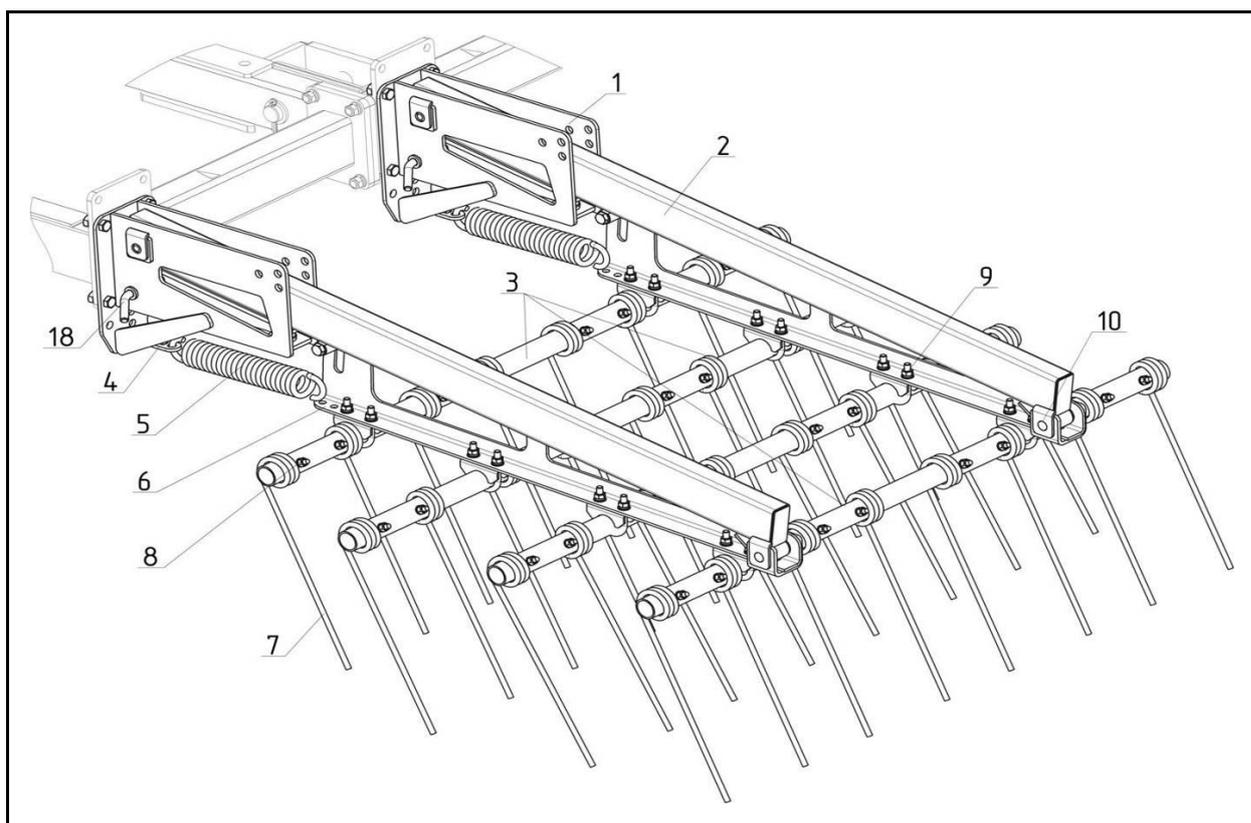
1 – Кронштейн; 2 – Поводок; 3 – Труба; 4 – Натяжитель; 5 – Пружина С60500; 6 – Основание;
