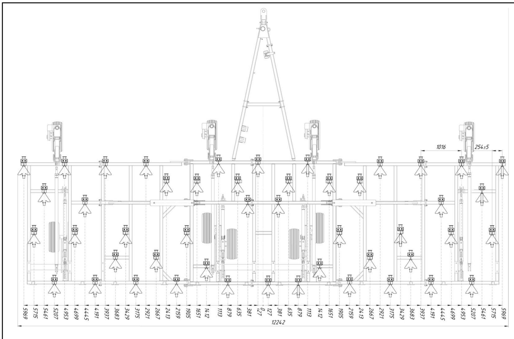
Рисунок Б.1 – Схема расстановки рабочих органов культиваторов К-12200 и К-12200-01
