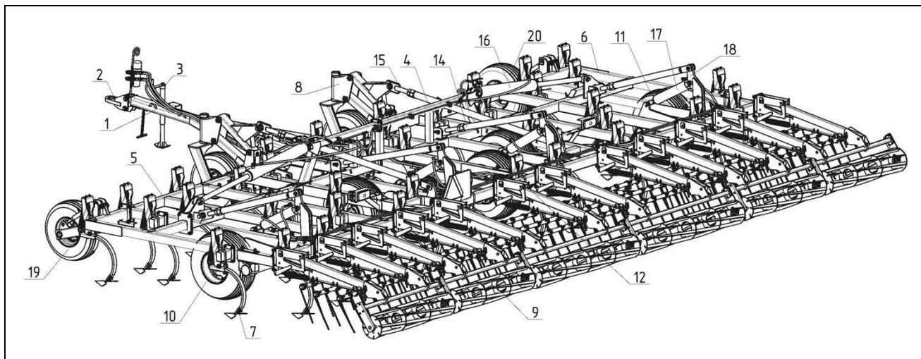
1 – Сница; 2 – Прицеп; 3 – Домкрат; 4 – Рама в сборе; 5 – Крыло левое; 6 – Крыло правое; 7 – Рабочий орган; 8 – Колесо флюгерное; 9 – Шлейф комбинированный; 10, 11 – Шасси крыла; 12 – Шасси; 13, 14 – Тяга регулировочная; 15 – Тяга синхронизации; 16 – Гидроцилиндр подъёма крыла; 17 – Гидроцилиндр шасси; 18 – Кронштейн; 19, 20 – Колесо опорное; 21 – Противооткатный упор
