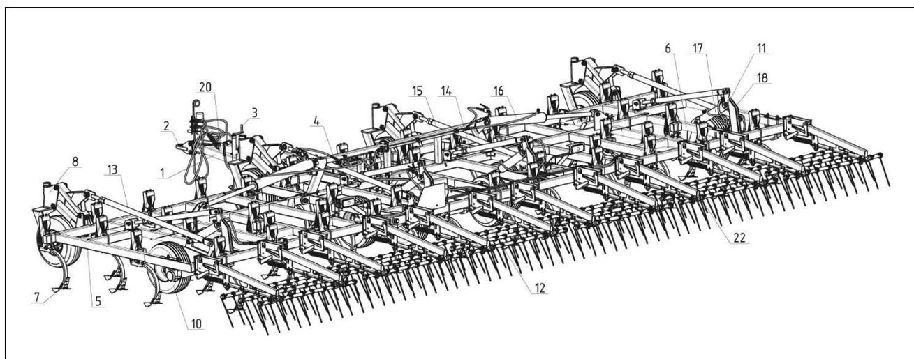
1 – Сница; 2 – Прицеп; 3 – Домкрат; 4 – Рама в сборе; 5 – Крыло левое; 6 – Крыло правое; 7 – Рабочий орган; 8 – Колесо флюгерное; 10, 11 – Шасси крыла; 12 – Шасси; 13, 15 – Тяга синхронизации; 14 – Тяга регулировочная; 16 – Гидроцилиндр подъёма крыла; 17 – Гидроцилиндр шасси; 18 – Кронштейн; 20 – Чистик; 22 – Шлейф пружинный (бороновальные модули)
