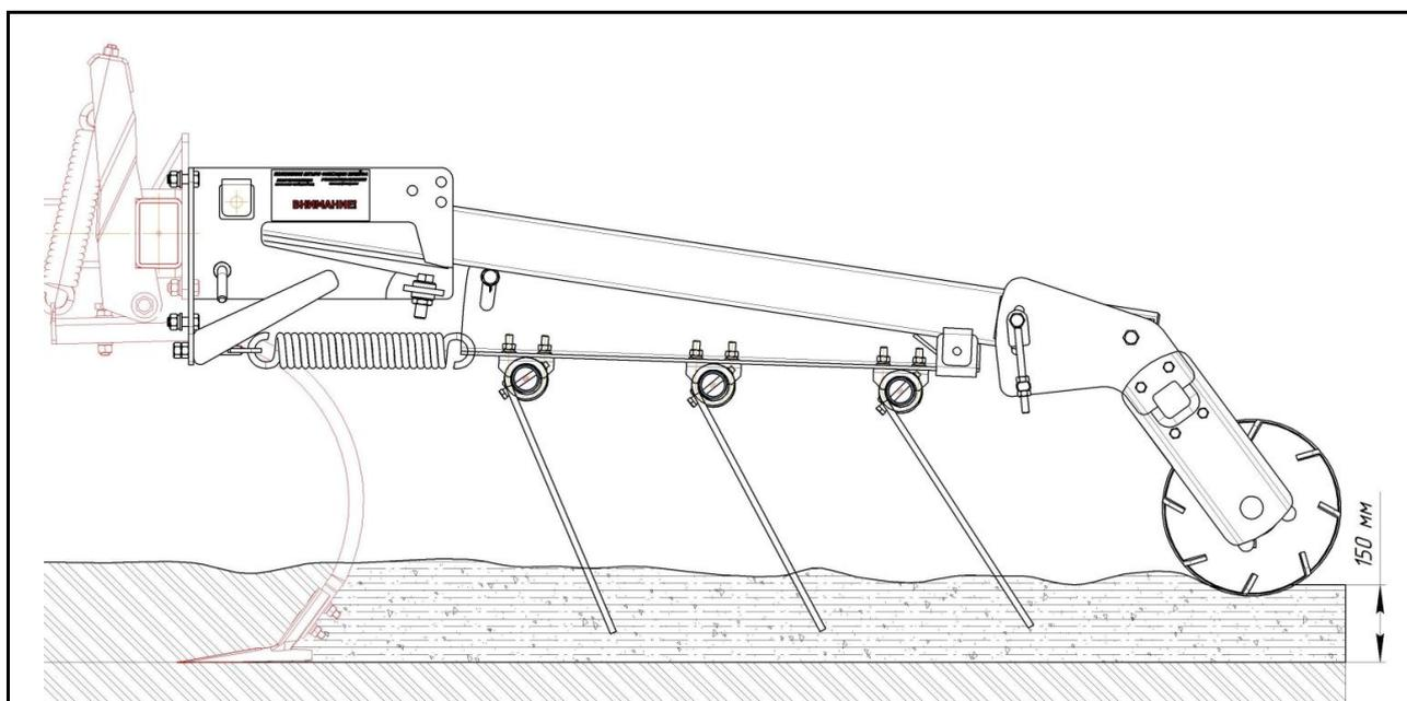
Рисунок 24.9 – Положение комбинированного шлейфа при глубине обработки 15 см
