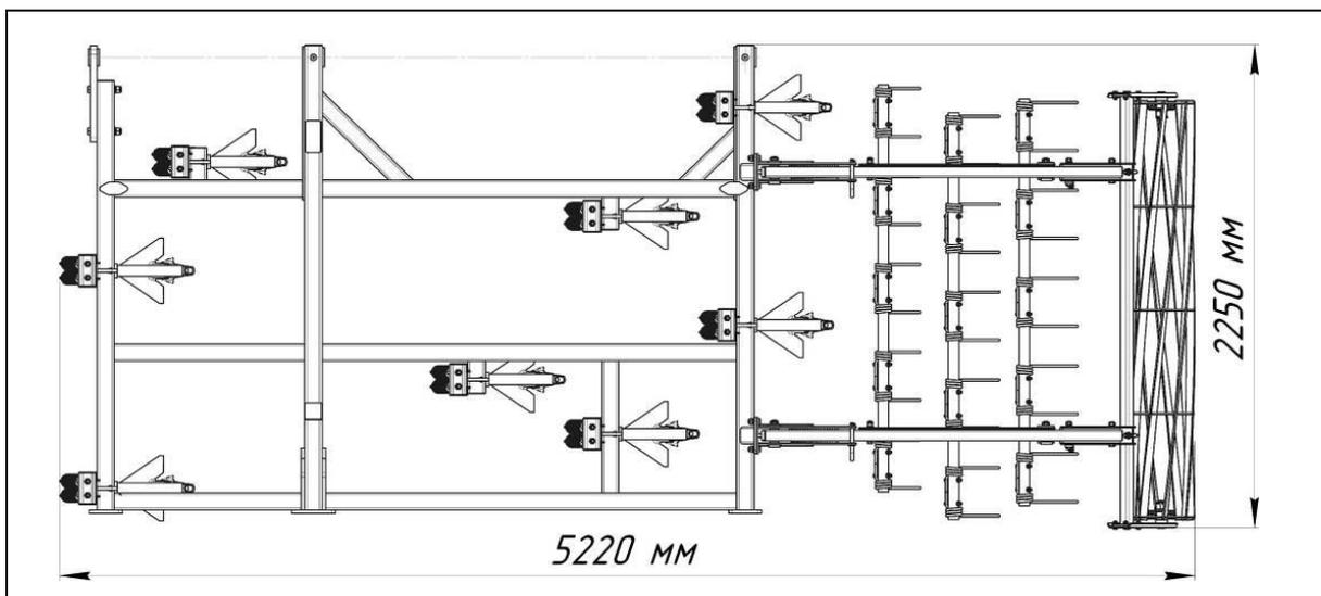
Рисунок 34 – Вид погрузочного места № 2 крыла, при частичной разборке
