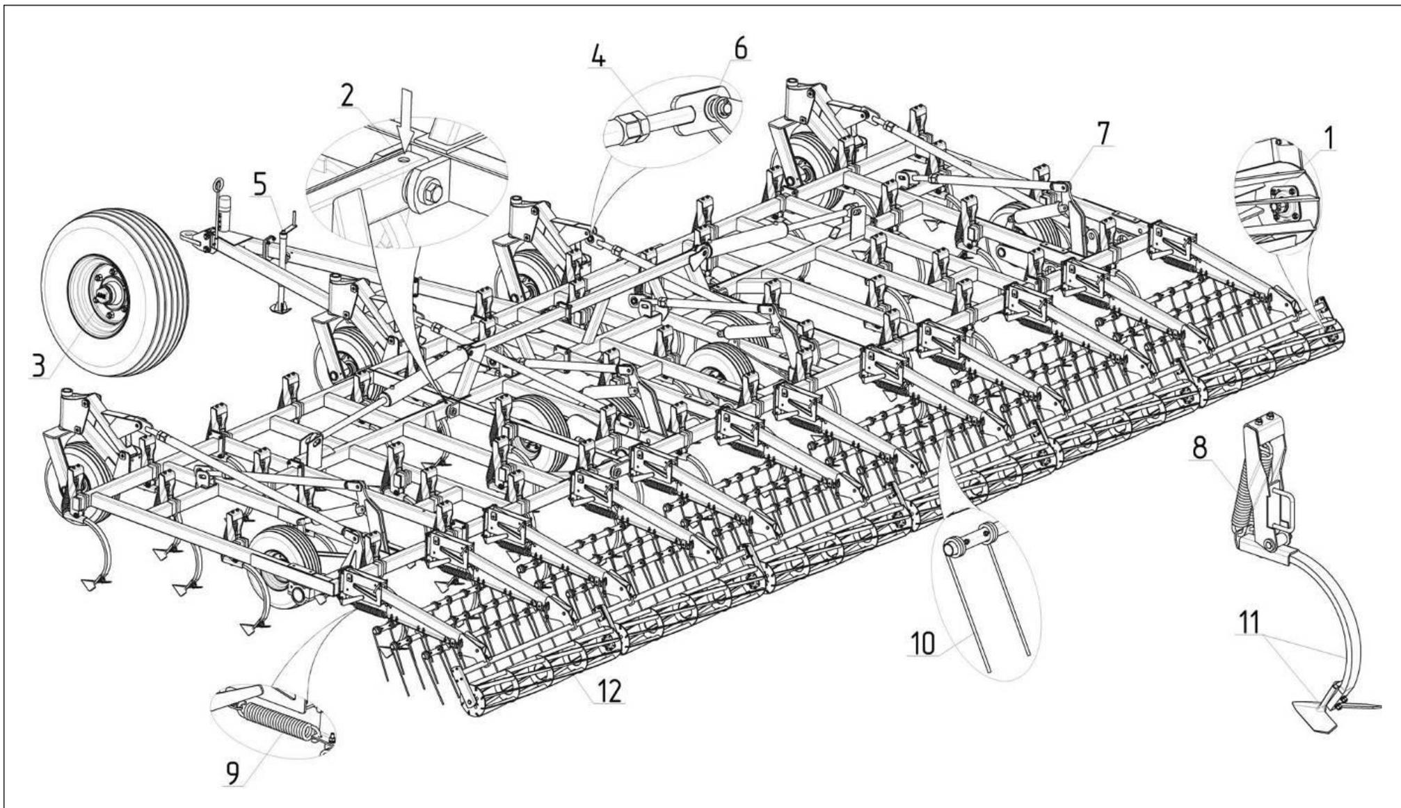
Рисунок 29 – Места смазки культиваторов К-10200 и К-12200
