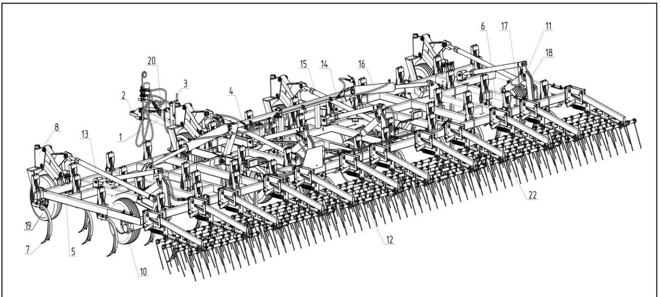
1 – Сница; 2 – Прицеп; 3 – Домкрат; 4 – Рама в сборе; 5 – Крыло левое; 6 – Крыло правое; 7 – Рабочий орган; 8 – Колесо флюгерное; 10, 11 – Шасси крыла; 12 – Шасси; 14 – Тяга регулировочная; 15 – Тяга синхронизации; 16 – Гидроцилиндр подъёма крыла; 17 – Гидроцилиндр шасси; 18 – Кронштейн; 19, 20 – Колесо опорное; 22 – Шлейф пружинный (бороновальные модули)
