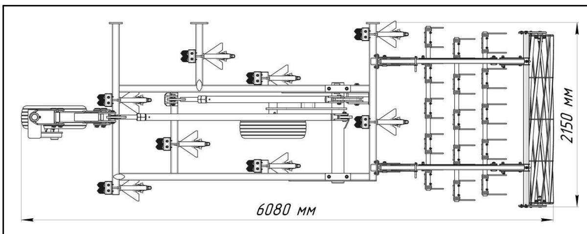
Рисунок 33 – Вид погрузочного места № 1 крыла, при частичной разборке
