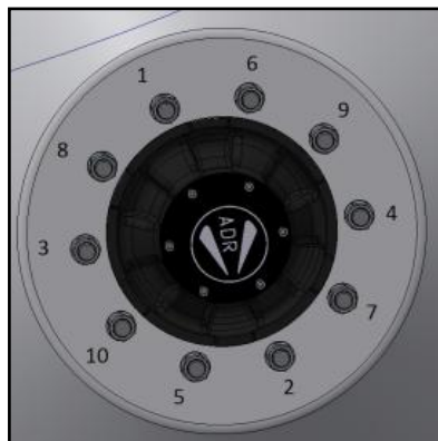
Рисунок 5.1 – Порядок затяжки колесных гаек
