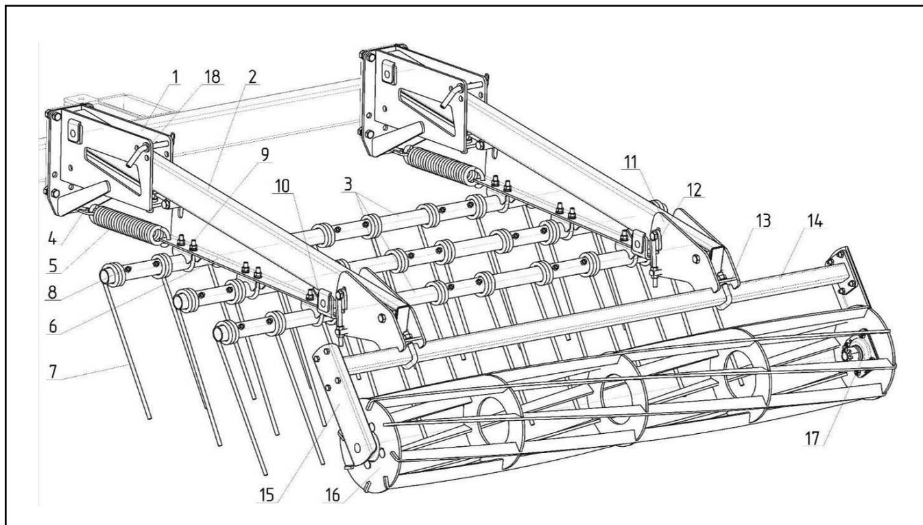
1 – Кронштейн; 2 – Поводок; 3 – Труба; 4 – Натяжитель; 5 – Пружина С60500; 6 – Основание;
