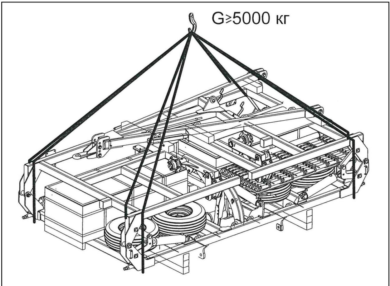
Рисунок 25 – Схема строповки для культиватора К-8200-01
