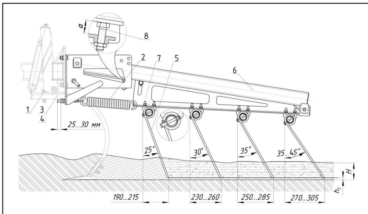
$h_1 = 0...30$  мм – высота установки пружинных зубьев бороновального модуля;
