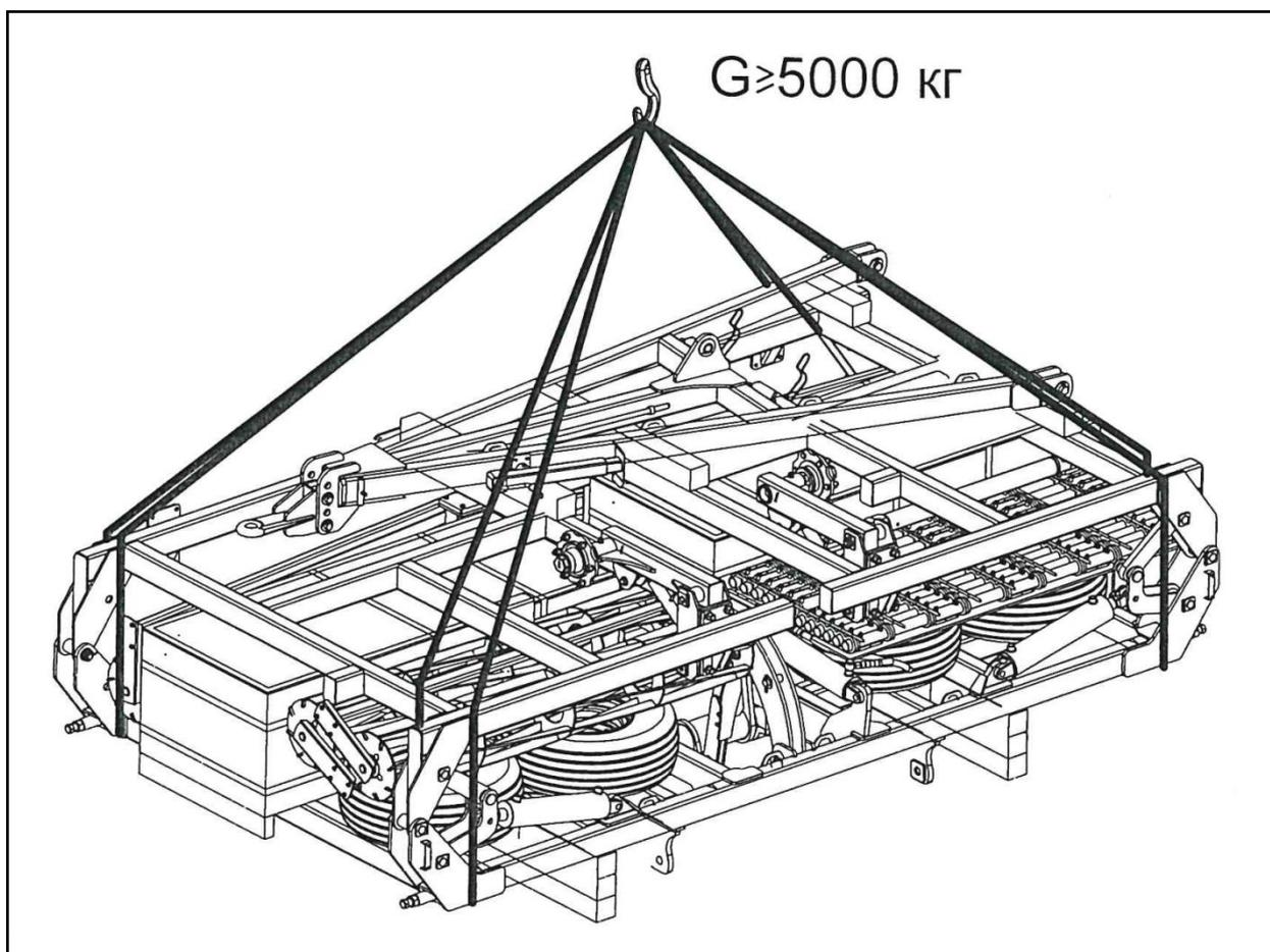
Рисунок 24 – Схема строповки для культиватора К-8200
