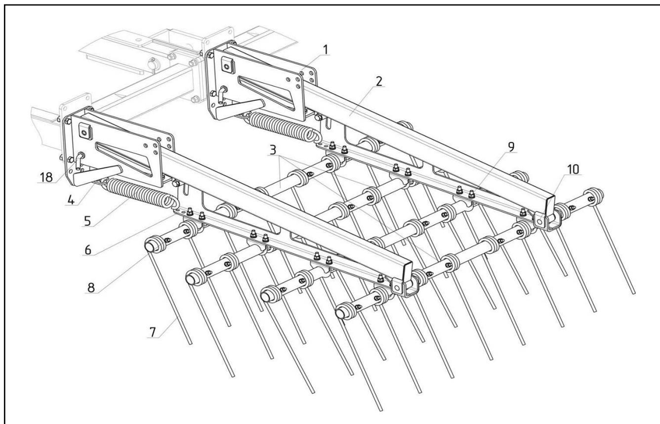
1 – Кронштейн; 2 – Поводок; 3 – Труба; 4 – Натяжитель; 5 – Пружина С60500; 6 – Основание;
