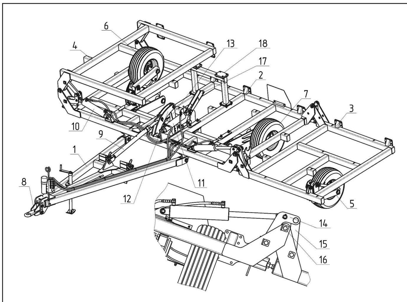
1 – Сница; 2 – Рама; 3 – Крыло левое; 4 – Крыло правое; 5, 6 – Колесо копирующее; 7 – Шасси; 8 – Прицеп; 9 – Тяга сннца; 10 – Гидроцилиндр подъёма крыла; 11 – Гидроцилиндр подъёма шасси; 12 – Рычаг; 13 – Тяги рычага; 14 – Рычаг, 15 – Тяга; 16 – Ось; 17 – Транспортный упор; 18 – Опора
