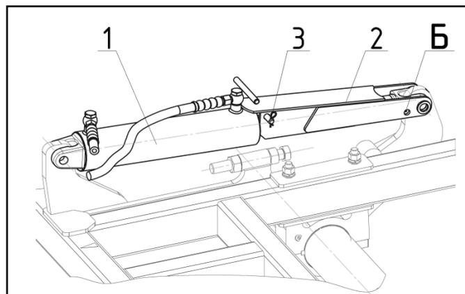
**Положение упора при транспортировке**
