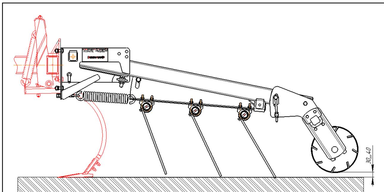
Рисунок 18.5 – Установка катка комбинированного шлейфа
