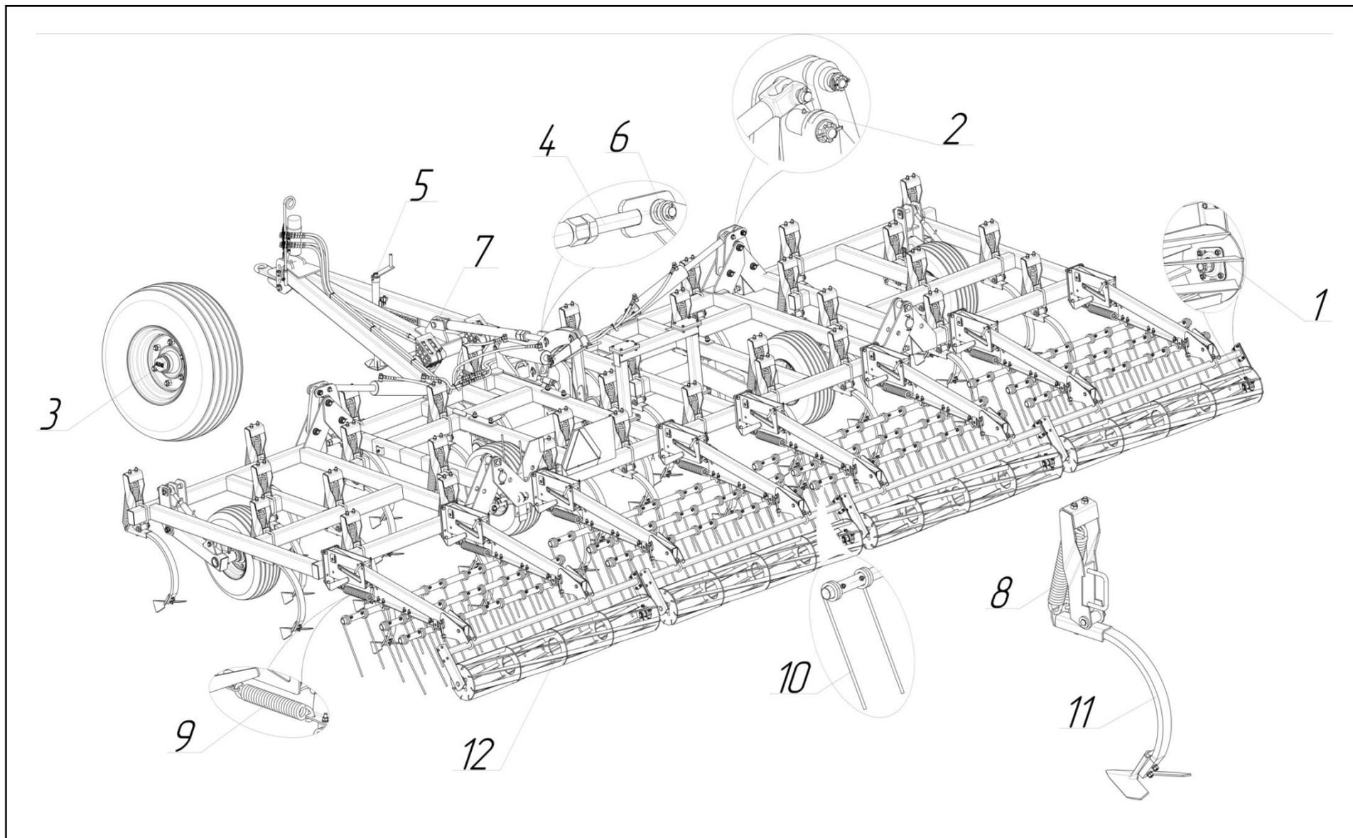
Рисунок 23 – Места смазки культиватора К-8200
