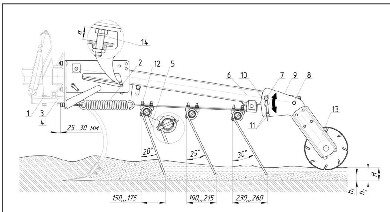
$h_1 = 0...30$  мм – высота установки пружинных зубьев бороновального модуля;
