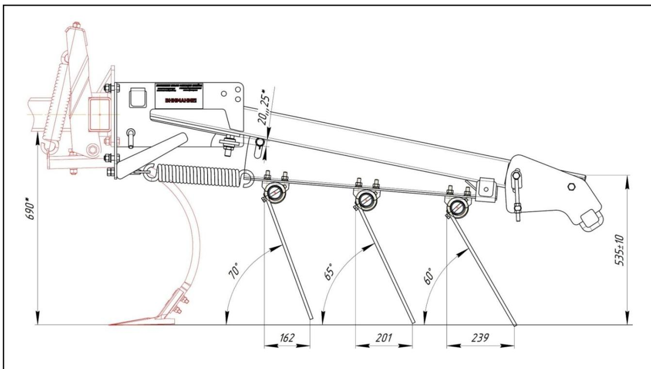
Рисунок 18.3 – Установка граблин комбинированного шлейфа
