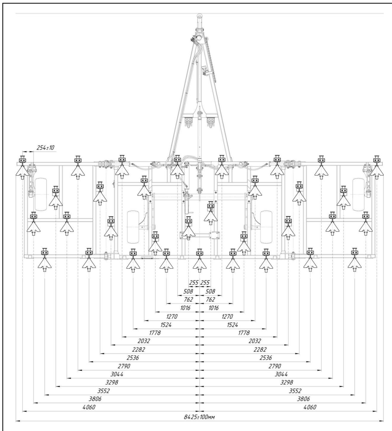
Рисунок Б.1 – Схема расстановки рабочих органов
