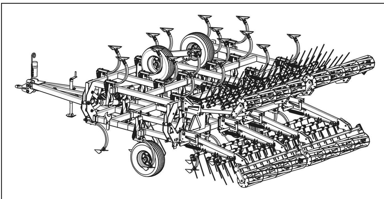
Рисунок 6 – Культиватор для сплошной обработки почвы К-8200.
