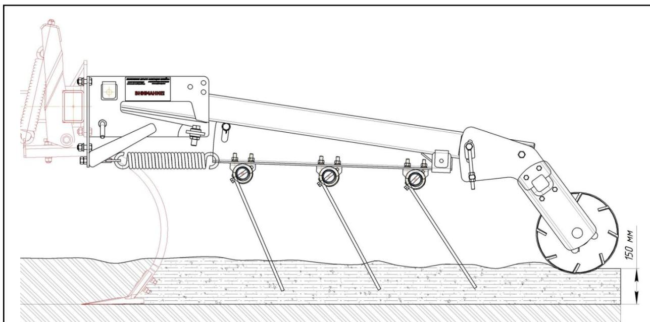
Рисунок 18.7 – Положение комбинированного шлейфа при глубине обработки 15 см
