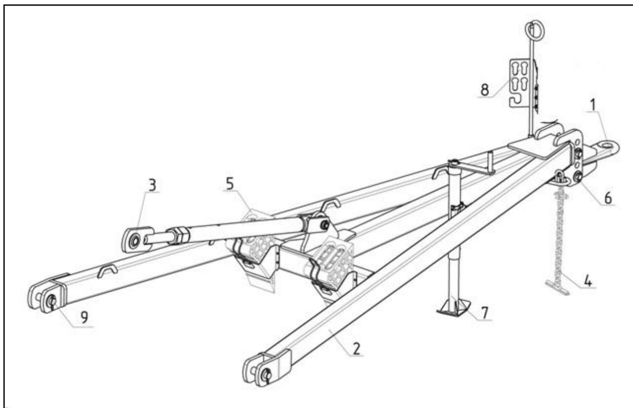
1 – Прицеп; 2 – Сница; 3 – Тяга; 4 – Цепь страховочная; 5 – Противооткатный упор; 6 – Ось; 7 – Домкрат; 8 – Стойка крепления РВД; 9 – Ось
