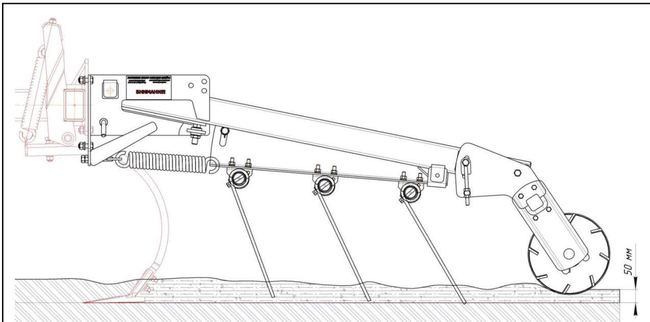
Рисунок 18.6 – Положение комбинированного шлейфа при глубине обработки 5 см
