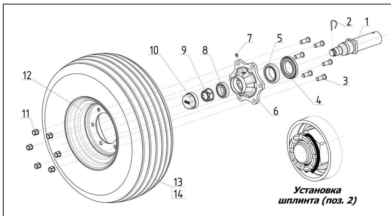
1 – Ось колеса; 2 – Шплинт пружинный; 3 – Болт 9RC18-16G; 4 – Защитное уплотнение; 5 – Подшипник; 6 – Ступица; 7 – Маслёнка; 8 – Подшипник; 9 – Гайка; 10 – Колпачок; 11 – Гайка 57548B2 (9DR18GER-16); 12 – Колесо 9.00x15.3; 13 – Шина 10,0/75-15,3; 14 – Камера 10-15HS 10/75-15.
